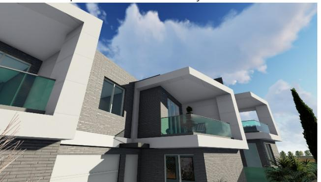
**CARPINTERÍA EXTERIOR.** Carpintería exterior de PVC color blanco con un elemento de apertura y oscilobatiente y el resto en carpintería fija. Persianas de lamas de aluminio lacadas inyectadas en poliuretano en todas las dependencias y terminación en color de la carpintería. El acristalamiento en carpinterías exteriores, doble acristalamiento Climalit o similar con cámara de aire (4/12/3+3) Bajo Emisivo, para mejor control de la transmitancia térmica).
