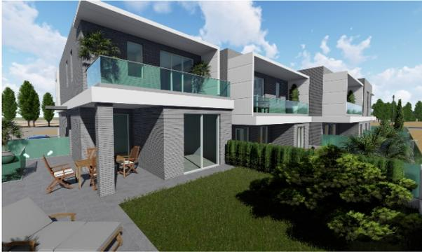
**FACHADA.** Las fachadas estarán formadas por diversos materiales destacando el ladrillo en color, con mortero del mismo tono, e inserciones en cotegrán, marcando despiece de fachadas y huecos según diseño del proyecto. Aislamiento térmico-acústico (interior y exterior) sobre muro base de ladrillo y trasdosado igual.
