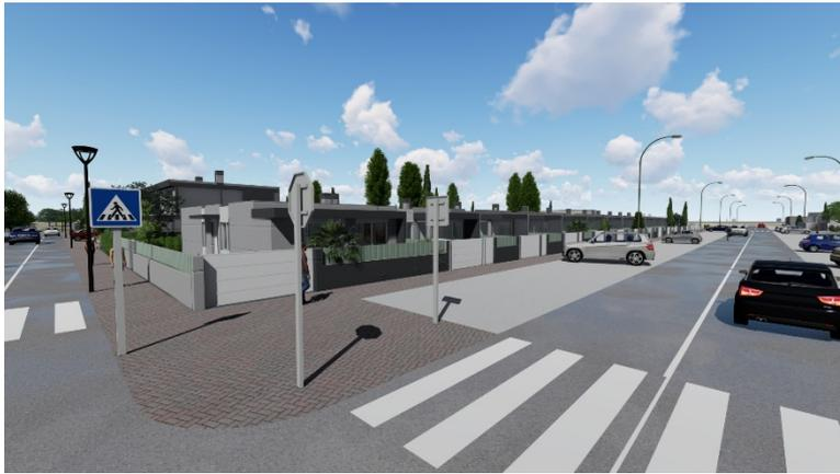
**EDIFICACION** Las viviendas se edifican de manera individual aunque se sitúan al lado una de la otra, cada una cuenta con sus pilares, chimeneas de ventilación cubiertas y aislamientos independientes de la vivienda aneja.
