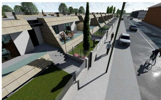
**CERRAMIENTOS EXTERIORES (FACHADAS).** Cerramiento exterior en **Piedra moca / Piedra Arenisca**, combinando colores y acabados, marcando despiece de fachadas y huecos según diseño del proyecto.
